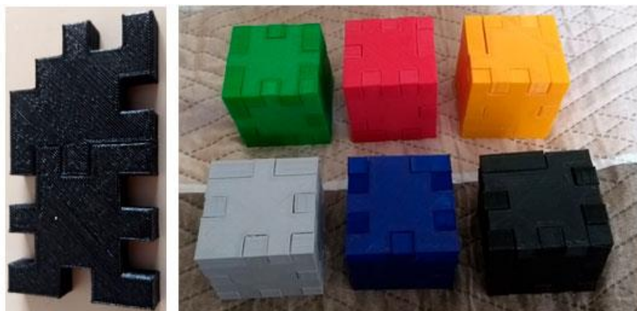
Figura 4 – Teste de encaixe das peças a esquerda e a direita cubos já montados
